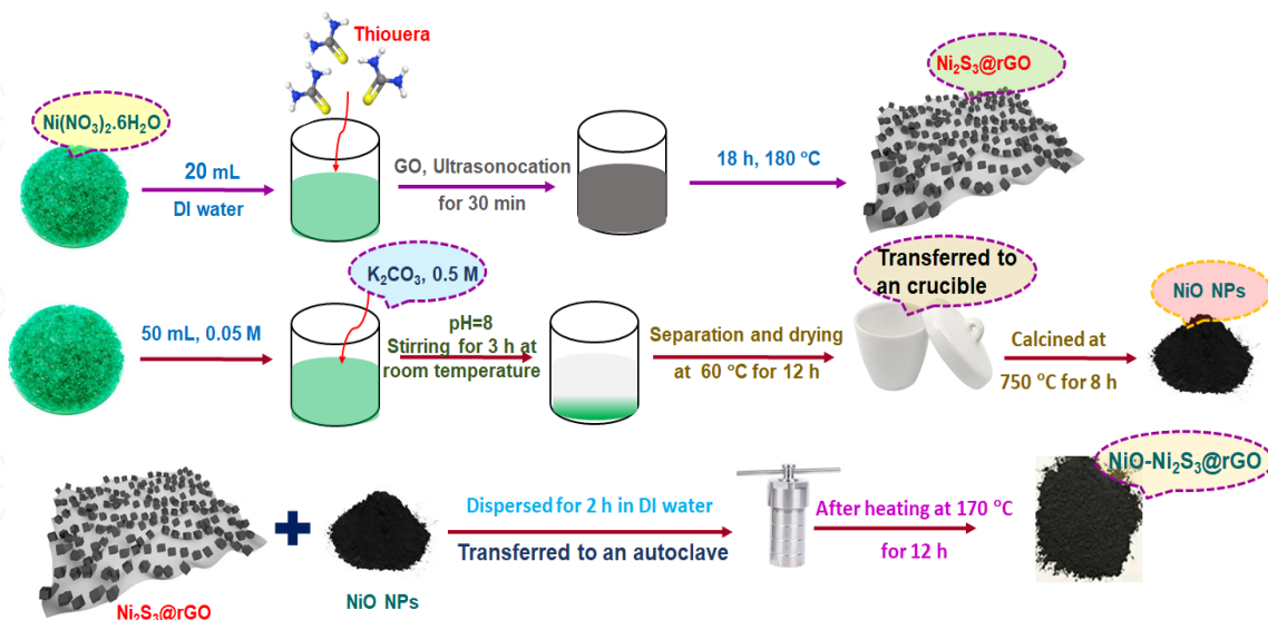
شکل ۱: مراحل تهیه ساختار ناهمگون NiO-Ni 2 S 3 @rGO
