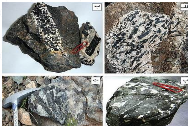
شکل ۳: الف و ب: بخش های عدسی مانند فلدسپاتی با بلورهای درشت و شکل دار آمفیبول در داخل بخش مافیکی، پ) نمونه دستی یک هورنبلندیت با مگاکریست های درشت آمفیبول، ت) نمونه صحرایی از مگاکریست های آمفیبول در یک متن فلدسپاتی.
