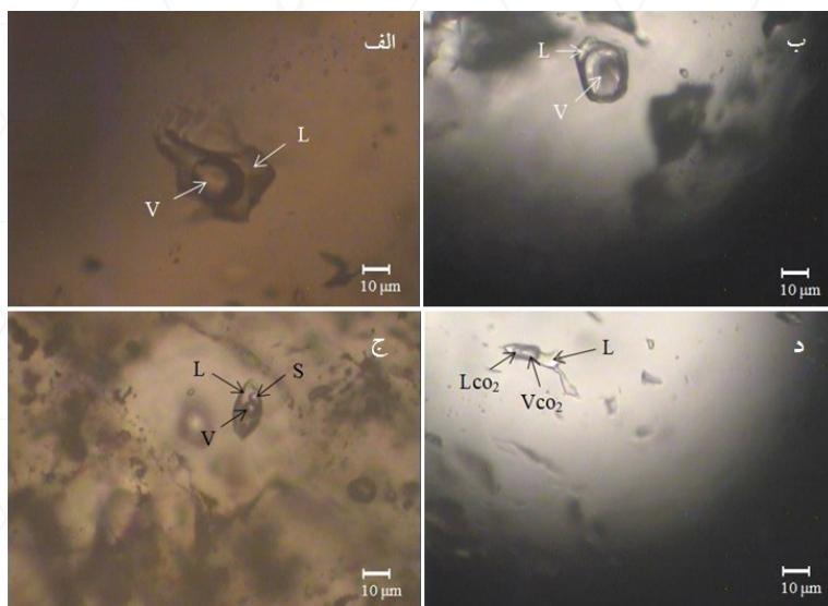
شکل ۳ طبقه‌بندی میانبارهای سیال کانسار سلسیت پاپکوه. الف) میانبار سیال نوع I (L+V)، ب) میانبار سیال نوع II (V+L)، ج) میانبار سیال نوع III (L+V+S) و د) میانبار سیال نوع IV (L+Vco 2 + Lco 2 ).
