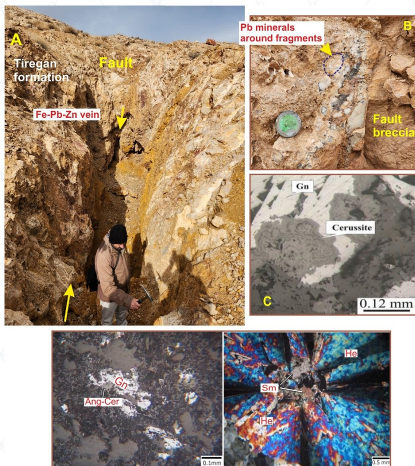
شکل ۳. انواع ساخت‌های کانی‌سازی سرب و روی در زون اسفراین. پدیده جانشینی سروزیت به جای گالن در شکل C نشان داده شده است. Sm: اسمیت زونیت، He: همی‌مورفیت، Ang: انگلزیت، Gn: گالن
