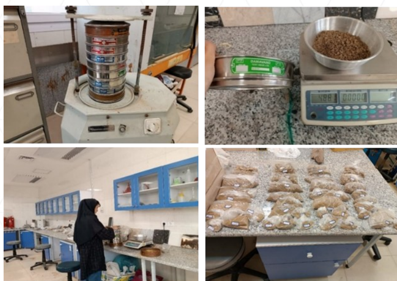
شکل ۳: مراحل مطالعه نمونه‌های برداشت‌شده در آزمایشگاه
