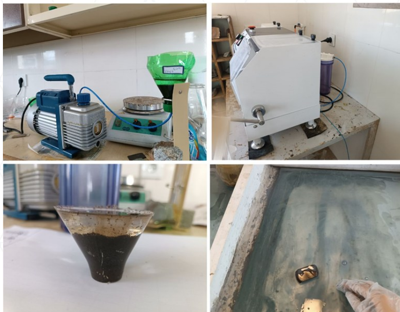
شکل ۴: مراحل تهیه مقطع نازک از نمونه‌ها
