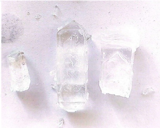
شکل ۶: بلور دی هیدروژن پتاسیم فسفات همراه با ناخالصی تالیم
