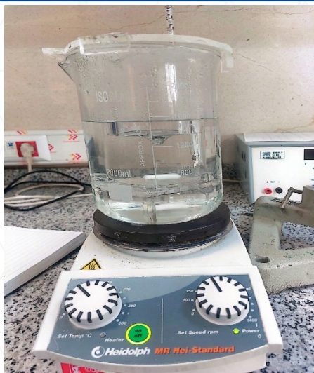
شکل ۴: چیدمان دستگاه رشد بلور از محلول
