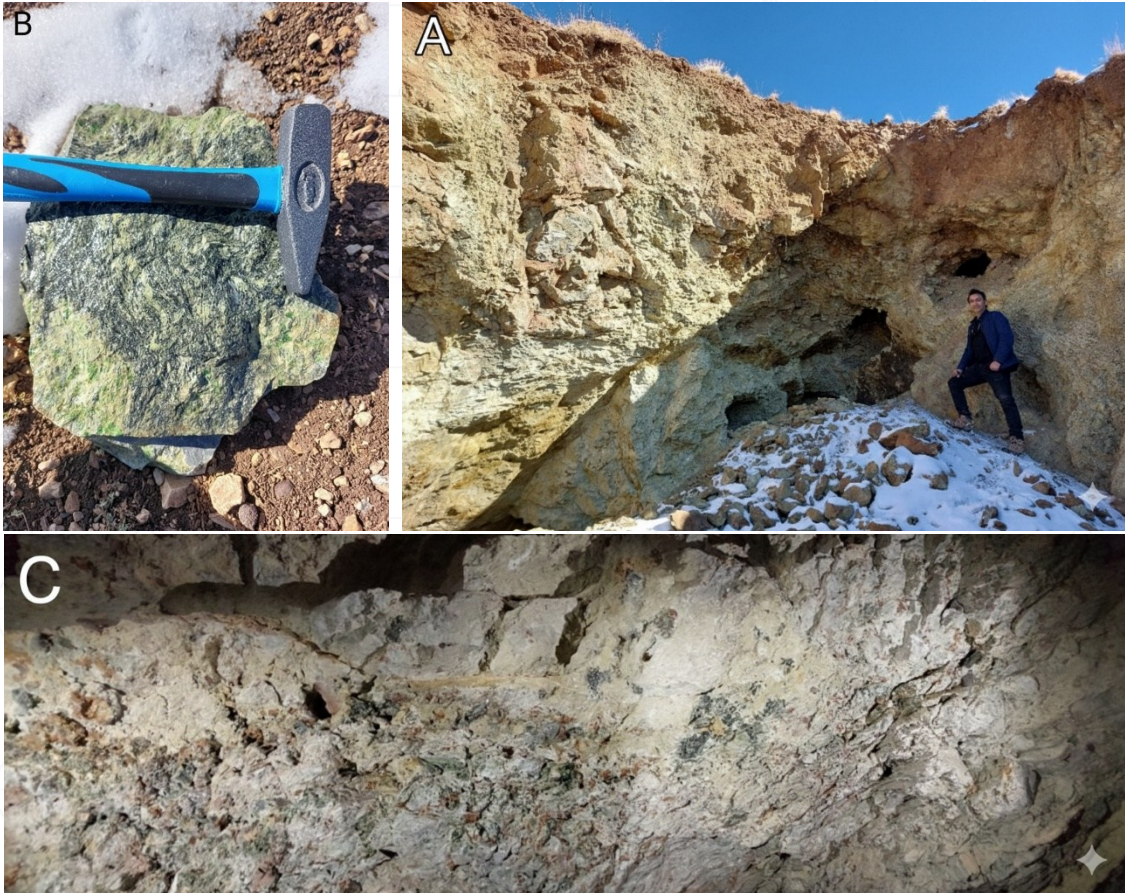
شکل ۳. تصویر A: کارگاه استخراج دمانتوئیدهای کوه بلقیس به صورت تونل‌های تجربی یا تصادفی با عمق کم را نشان می‌دهد. تصویر B: سنگ میزبان دمانتوئید کوه بلقیس که با بررسی میدانی، گنایس به نظر می‌رسد. و تصویر C: سنگ میزبان دمانتوئیدهای کوه بلقیس که با بررسی میدانی، میکاشیست، مرمر به نظر می‌رسند.
